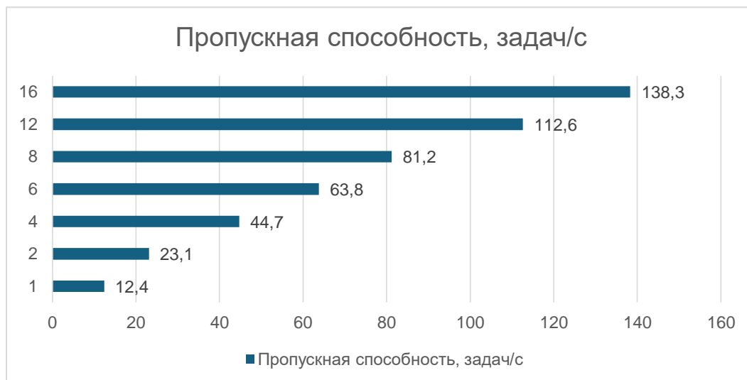
Рисунок 2 - Зависимость пропускной способности от количества вычислительных узлов
